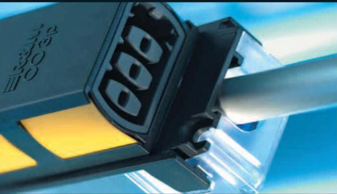
پاور RCO این امکان را فراهم می‌کند تا نصب سریع‌تر، ساده‌تر و انعطاف‌پذیرتر از همیشه انجام شود. با این محصول شما می‌توانید در مدت ۴۰ ثانیه از یک کابل برق انشعاب بگیرید. نحوه کار این محصول که امروزه باعث کارایی بالای نصب شده این است که تماس از طریق یک سوکت ICD شرکت آر اند ام (R&M) و بدون نیاز به ابزار ایجاد می‌شود و با یک سیستم Easy Lock پوشانده می‌شود.
